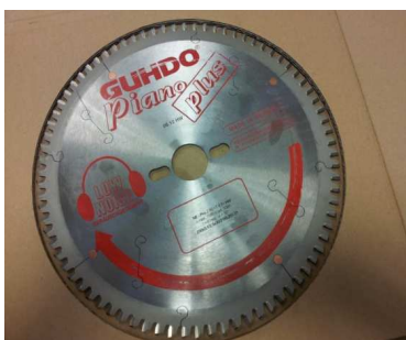
2.1 Lama per sega circolare: n. 80 denti, diametro 250 mm, diametro foro 32 mm, n. giri 8000 max
